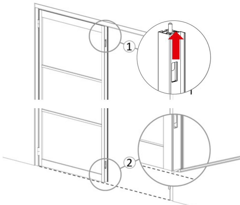
18. Dek het gat in de grond af met een van meegeleverde afdekplaatjes indien gewenst. Er is keuze uit een lijm- of schroefvariant.
