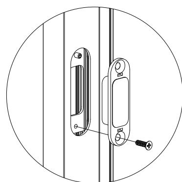
26. Draai de stelschroef uit het bovenste gat.
