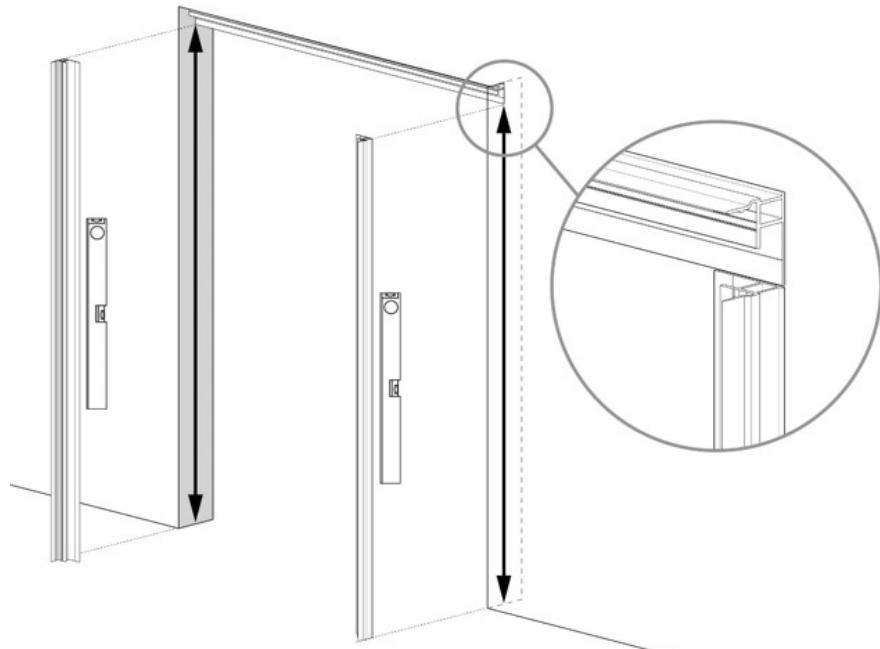
6. Fixez les profils de montage (niveau à bulle!) à gauche et à droite dans l'embrasure du mur selon la méthode de montage choisie. Faites attention à l'alignement avec le profil de montage en haut.
