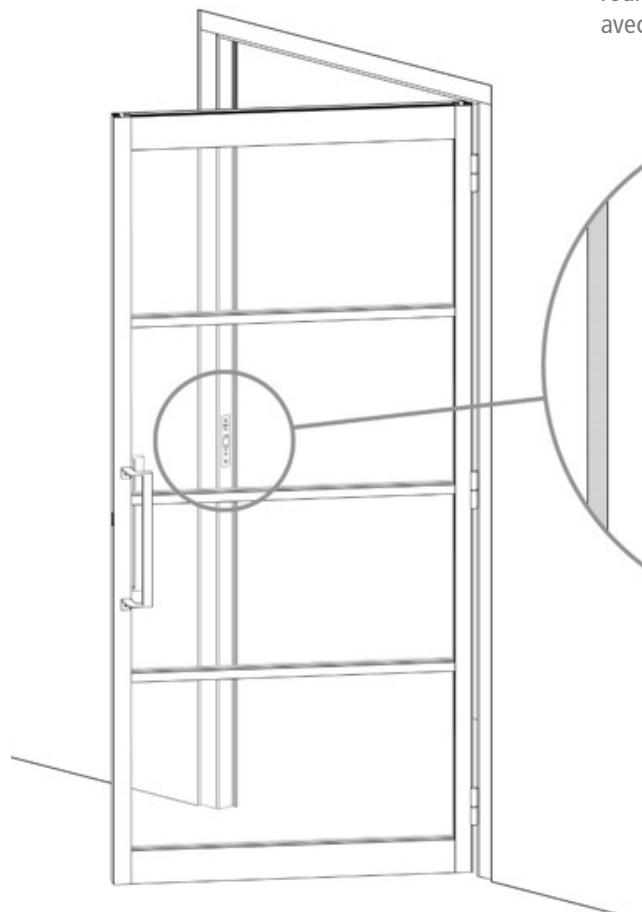
21. Vérifiez la fermeture de la porte. Si nécessaire, ajustez le rouleau de serrure (tournez-le vers l'intérieur ou l'extérieur avec la vis de réglage).
