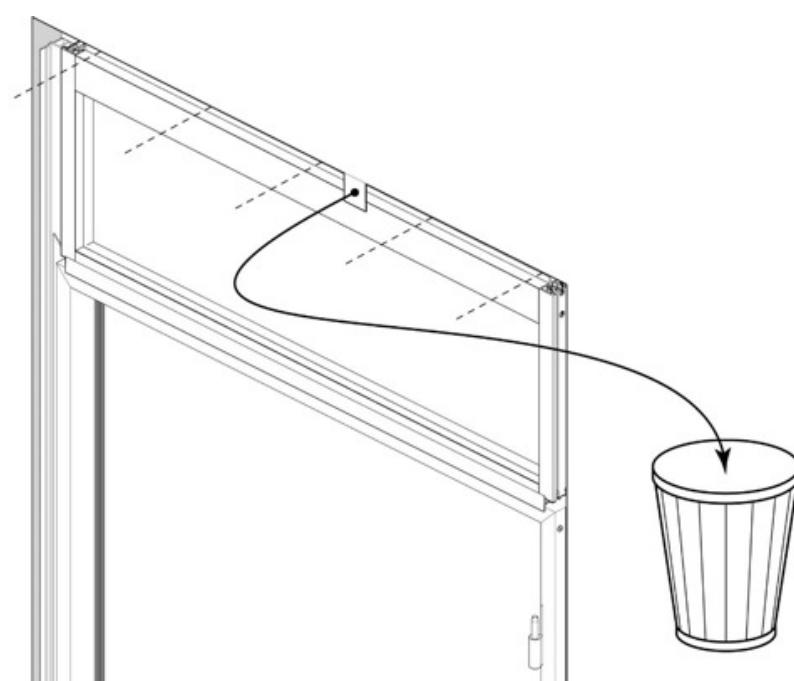
14. Fixez l'imposte vitrée contre le profil de montage avec des vis **F** (pré-perçage de Ø3 mm). Faites attention aux lignes de marquage (voir étape 9) pour déterminer la position correcte de la vis. Retirez le petit morceau de profil de recouvrement après l'installation.
