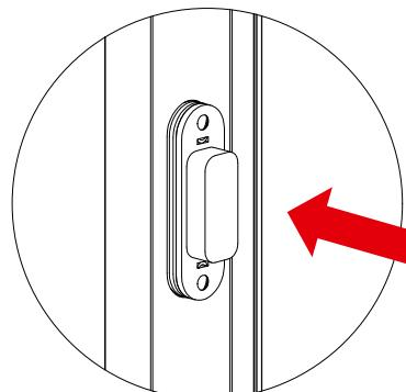
29. Controleer de sluiting van de deur. Om de trekkracht te verminderen bij gebruik van magneetsloten, verwijder het afdekkapje van de onderste of bovenste magneetsluiting en verwijder de stalen magneet uit de kunststof behuizing.
