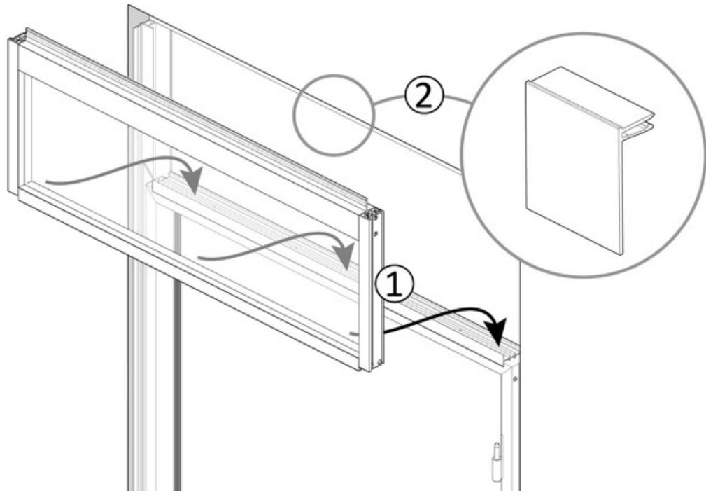
13. Placez l'imposte vitrée dans le profil de raccord (centré sur le cadre) et fixez temporairement le côté supérieur avec le petit morceau restant du profil de recouvrement (**E**).
