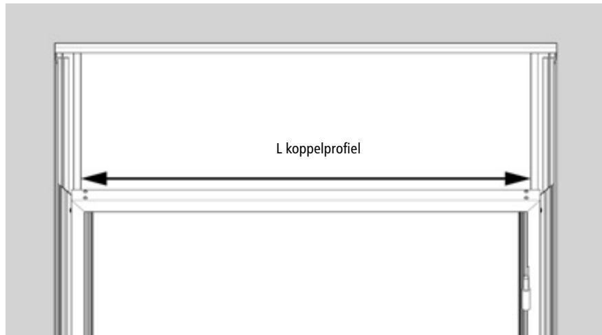
11. Plaats het koppelprofiel bovenop het kozijn. Zorg hierbij dat de klemvinger (binnenin het koppelprofiel) aan de achterzijde zit.
