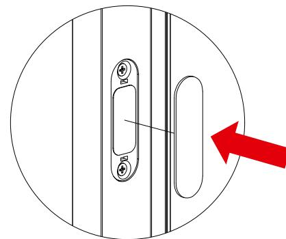
28. Plaats de tegenoverliggende magneet op de gemonteerd magneet om de bovenkant te bepalen. Monteer de magneet in deze positie in de deur of kozijn en volg stap 23-27.
