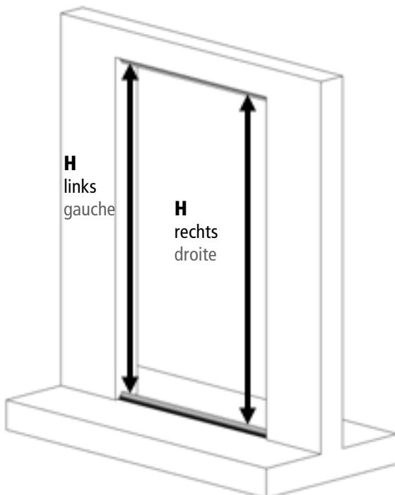
8. Meet links en rechts de afstand H tussen het montageprofiel boven en het montageprofiel onder.
