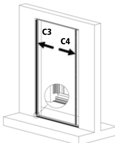
10. Draai een zeskantbout M5 x 30 mm (**A2d**) in de moer in het montage profiel die het dichtst bij het midden van het profiel ligt (lijn A). Stel dan de hoogte van de schroefkop op **19 mm** (bovenzijde gelijk met markering op montageprofiel). Monteer de overige bouten M5 x 30 mm op dezelfde hoogte (waterpas!) als de eerste bout. **LET OP**, bij sterk op- of aflopende vloeren moeten mogelijk de kortere of langere meegeleverde M5 bouten gebruikt worden.
