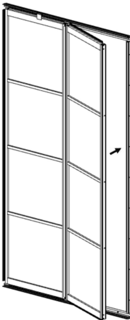
16. Glissez le panneau de cloison suivant **A** dans le profil de jonction et sur les vis hexagonales du profil de montage au sol.
