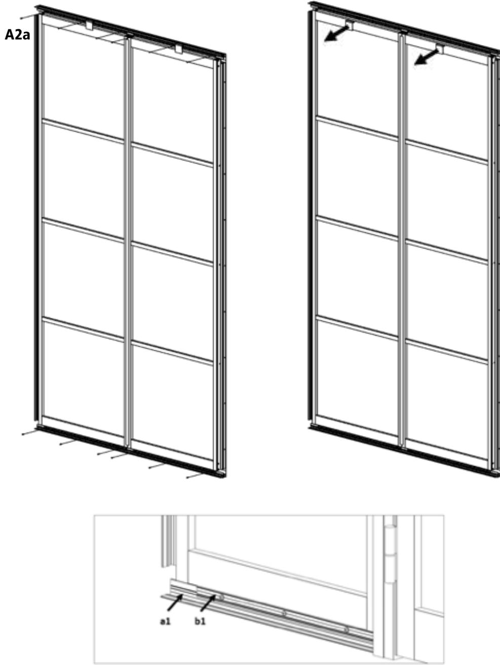
20. Vérifiez que l'espace entre les murs latéraux et les panneaux de cloison soit identique à gauche et à droite. Si ce n'est pas le cas il est possible de rectifier leur position en les glissant latéralement.
